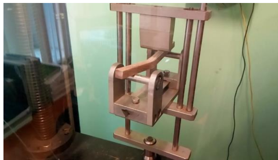
Рисунок 3 – Проведение испытаний для определения прочности модифицированной древесины на статический изгиб
